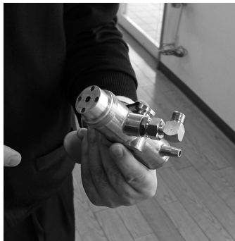
写真 8-3 フミンコーティング施工に活用されるスプレーガン 市販のガンより吹き出し口の穴を大きく加工している。
